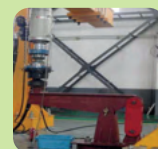
Test żywotności połączeń na zmęczenie materiału
